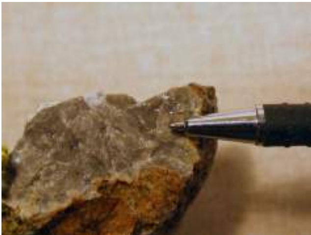
Slika 6.42: Siv mikriten apnenec, litotip D (foto: I. Rižnar).
