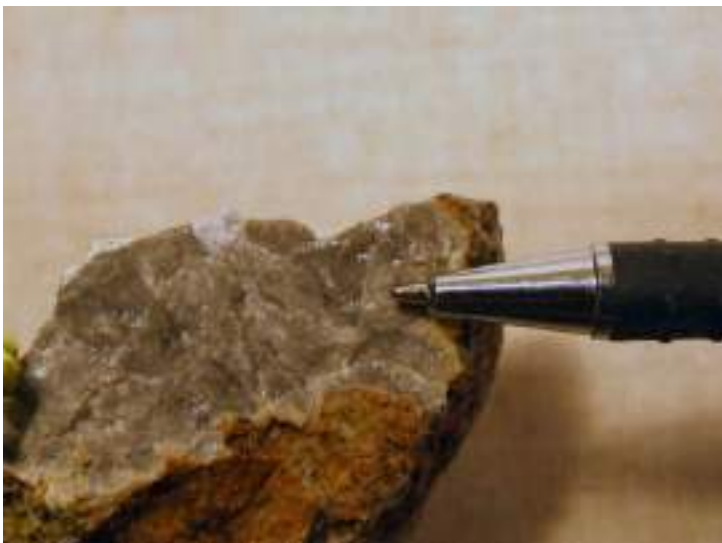
Slika 9. Siv mikriten apnenec - litotip D.
