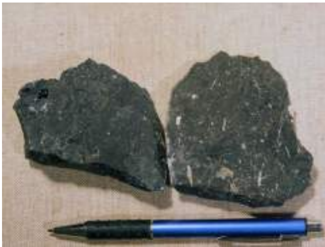
Slika 6.43: Črn mikriten apnenec tipa mudstone, litotip Ea (foto: I. Rižnar).
