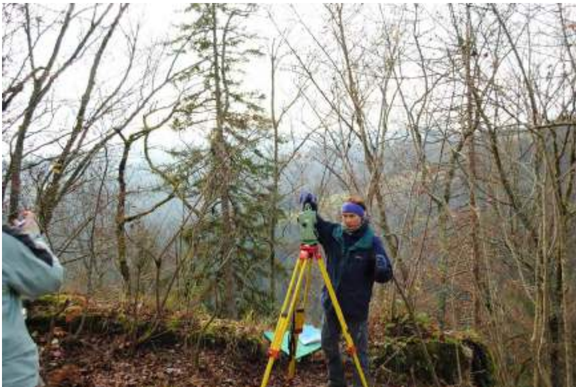
Slika 5.3: Geodetska izmera z elektronskim tahimetrom Leica TCR 307 (foto: B. Plohl; 22. 11. 2014, Nikon D3000, DSC_0006).
