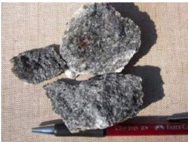
Slika 4. Siv debeložrnat peščenjak z apnenčevim vezivom – litotip As.
